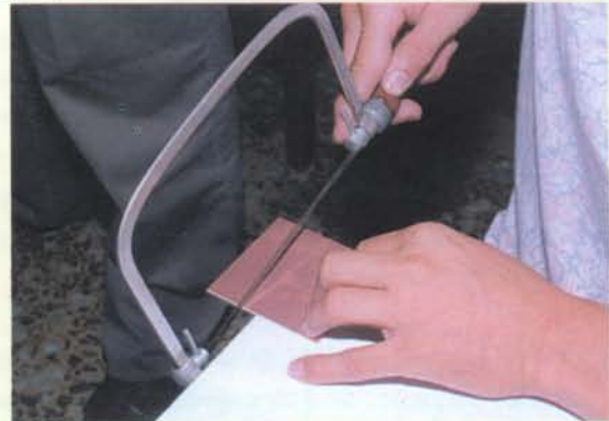
Figuras 5.20 y 5.21. Cortando la lámina sin procesar
